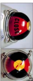
位置指示器 直接与轴相连, 显示连续位置。强力, 防腐, 透明的聚碳酸酯。清晰可靠 红一关, 黄一开
